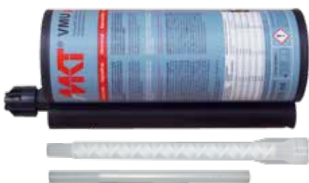
Kartuše VMU plus 825 Side-by-side kartuše s objemem 825ml, s velkou směšovací dýzou VM-XL a s prodlužovací trubičkou, pro vrty průměru nad 12 mm
